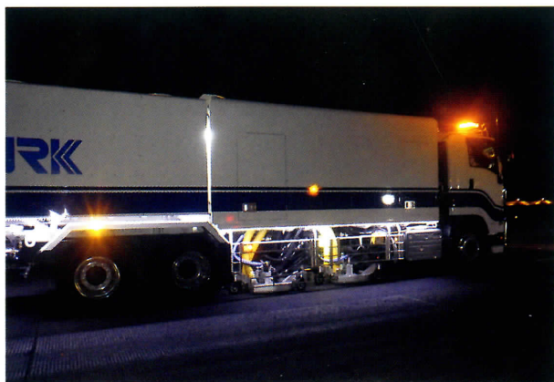
専用車両によるゴムの除去作業
